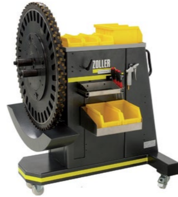
»eQuick 200« Ergonomikusan kialakított megoldás az optimális felszerszámzásra, ill. többelű főtengelymarók lapkázására
