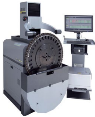
»gemini 2« Főtengelymarók beállításának és mérésének új generációja
