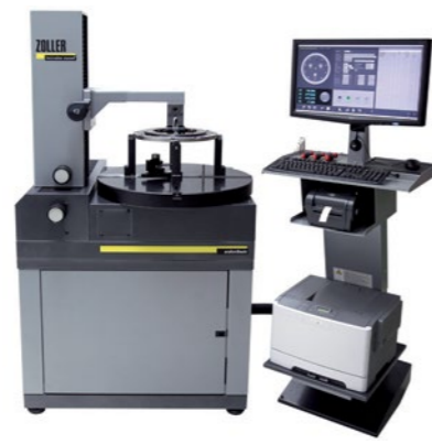
»aralonBasic« ZOLLER megoldás a belső szerszámélel rendelkező főtengelymarók folyamatközeli méréséhez
