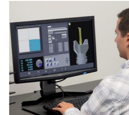
»caz« A ZOLLER által kifejlesztett, a világon elsőként bemutatott virtuális mérőgép. A »caz« a „computer aided ZOLLER” rövidítése, amely egy vonzó össz megoldást nyújt a »pilot 3.0« vezérlőszoftverbe történő teljes beágyazása által
