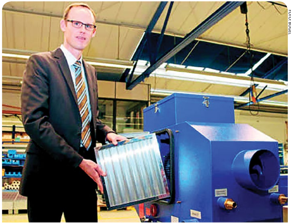
Az UMC-750-nel Rentschler cégvezető mutatja az új mechanikus leválasztórendszert, amelyre világszabadalmat jelentettek be
