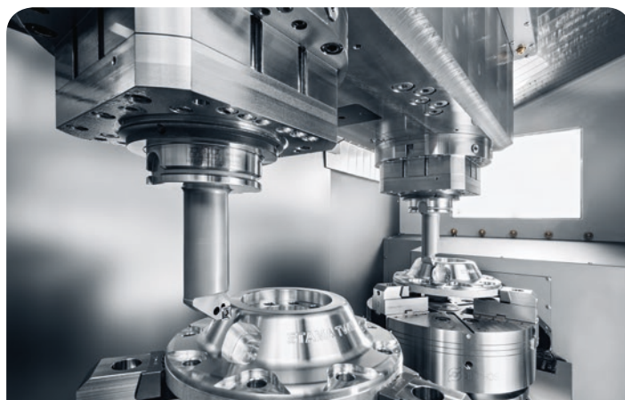
Dupla orsós esztergálás: a kombinált marás és esztergálás precizitásáról az orsók szenzoros pozicionálása gondoskodik
