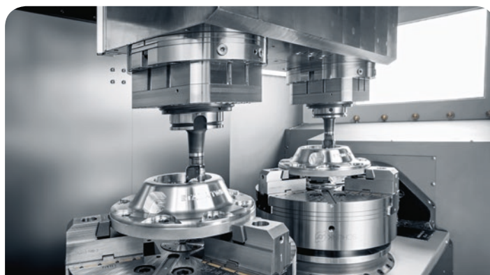
Dupla orsós HPC marás: az egyre nehezebb megmunkálható anyagokhoz az MT 838 Twin a modern precíziós szerszámok teljes arzenálját kínálja
