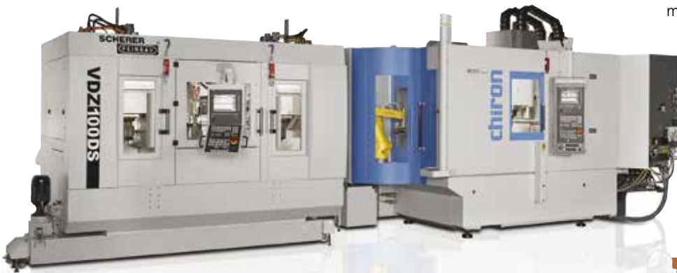
» Integrált automatizálás Variocell Uno egységgel: esztergálás Scherer VDZ 100/DS és marás Chiron DZ 12 W berendezéssel
