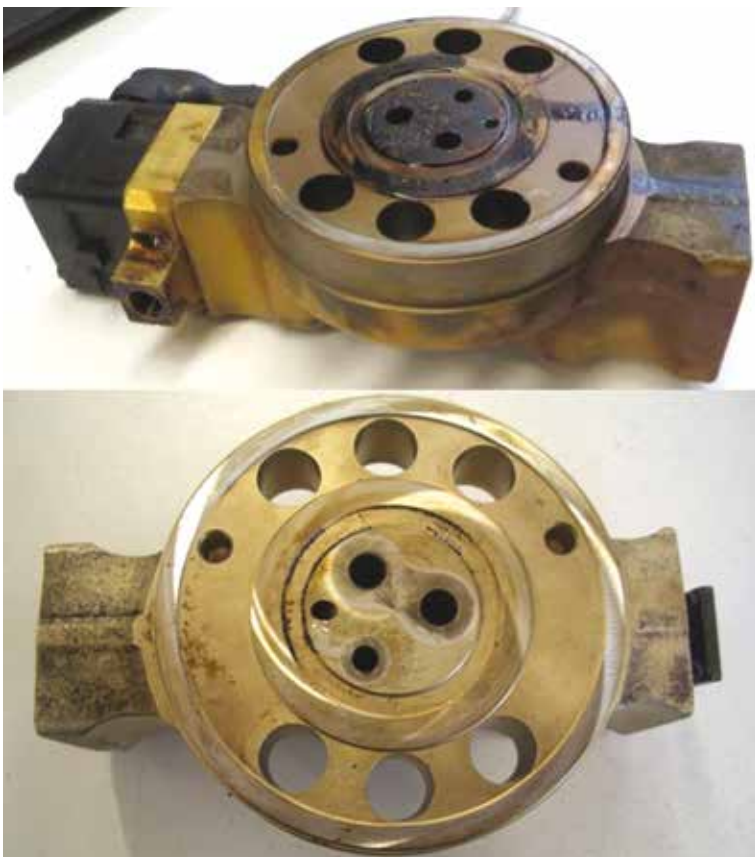
» Tehergépkocsi szelepegysége a felújítás előtt és után
