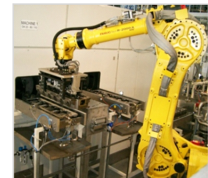
Beladung mit Roboter
