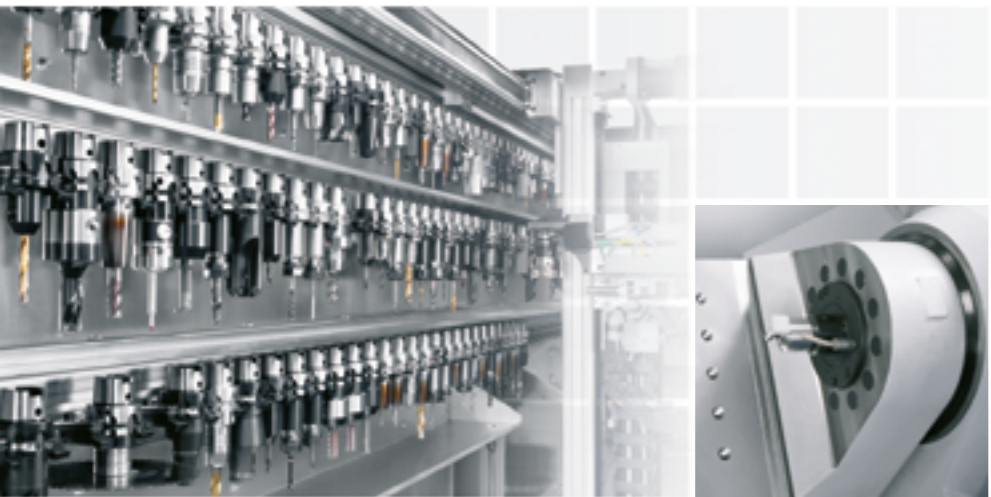
Hintergrundmagazin für die hauptzeitparallele Bereitstellung von bis zu 114 Werkzeugen.
