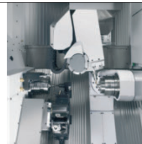
3 Blick in den Arbeitsraum der FZ12 MT mit Schwenkkopf, Drehspindel, Werkzeugrevolver und optionaler Gegenspindel
