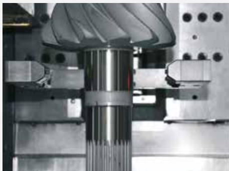
In Prozeß Wellenvermessung
