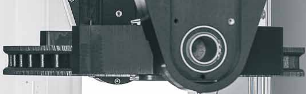
Rund Shuttle mit Pick & Place Einheit und Schwenkmodul
